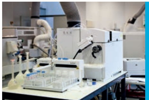
In het VMW-laboratorium werd in 2011 een tweede ICP-MS in dienst genomen voor de analyse van metalen
