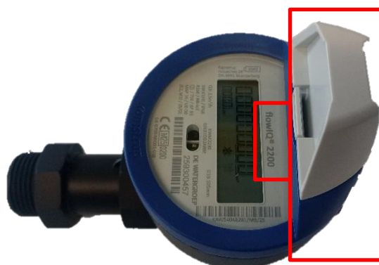
Afbeelding 23: watermeter Kamstrup flowIQ® 2200 met verlengstuk en antenne
