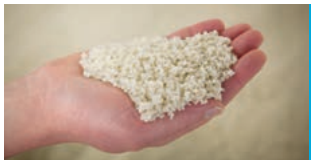
Kalkkorrels of pellets ontstaan na ontharding van drinkwater
